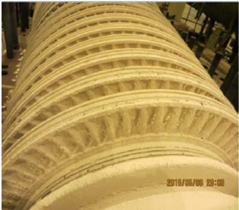
图 10 高压转子全貌
