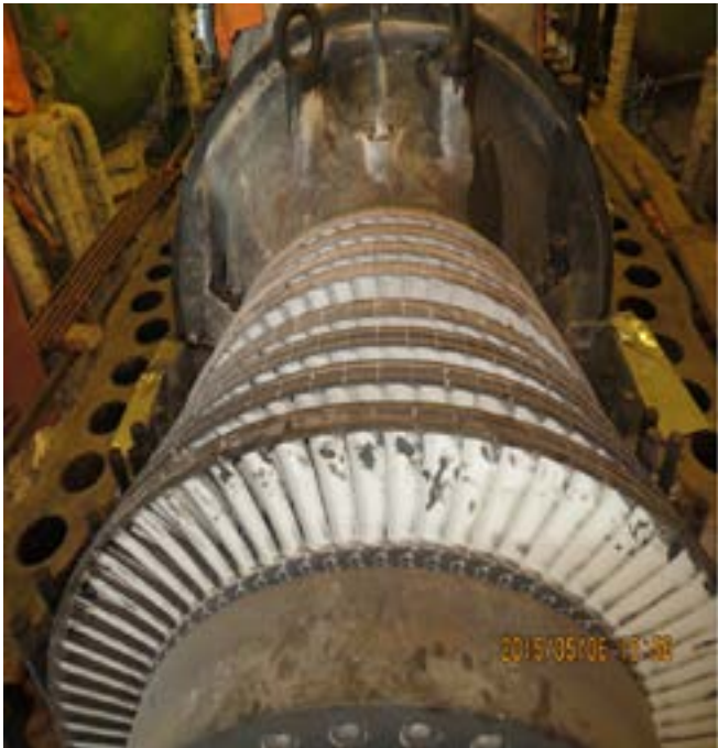
图 9 中压转子全貌
