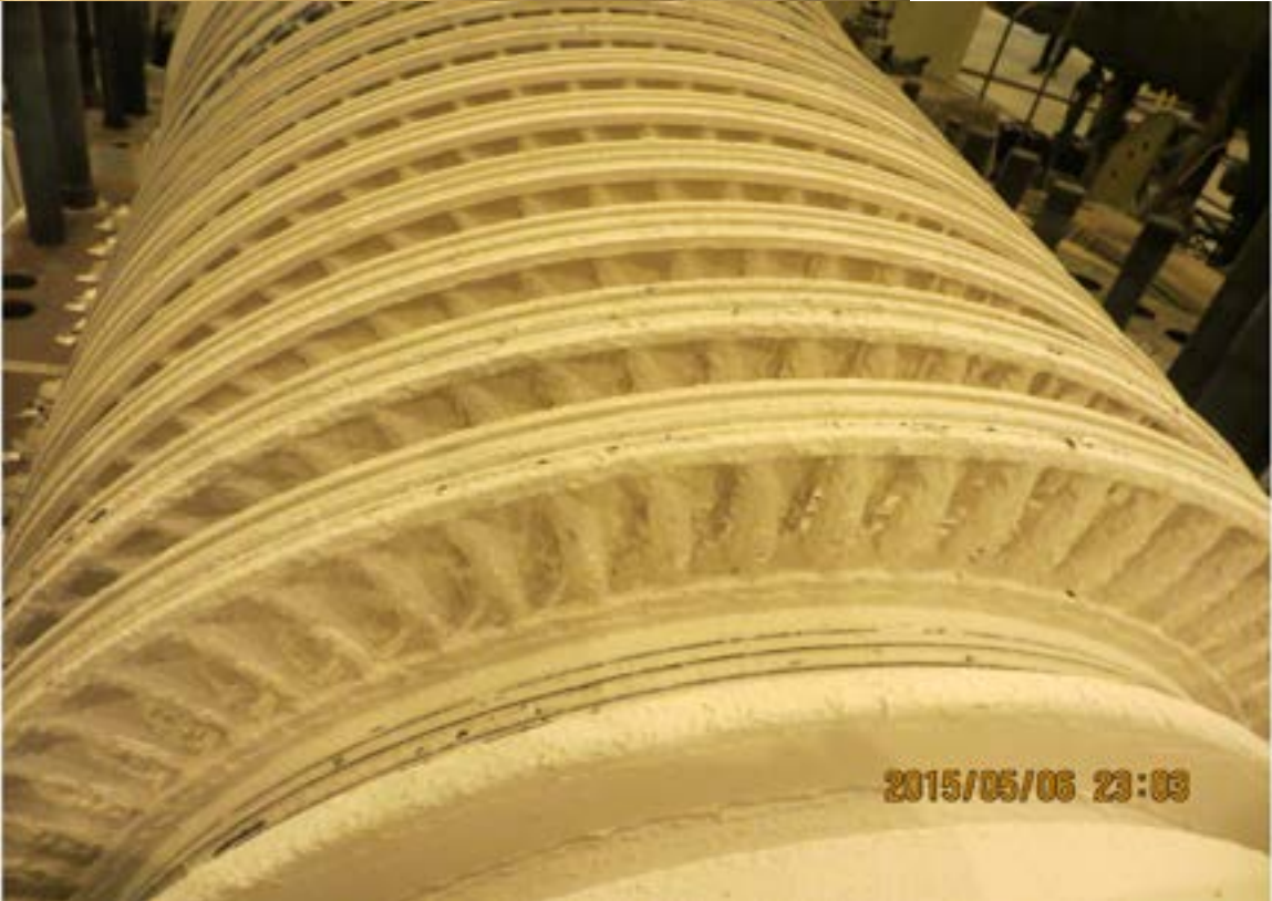
图 13 高压压力级动叶
